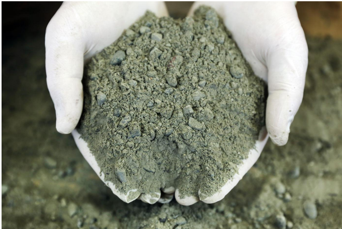
Fig. 1. MAGMENT magnetizable concrete.
